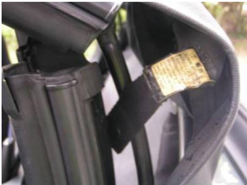
Pour ce faire la capote doit être à demie ouverte. Attention aux doigts. Il est conseillé d'être 2 pour la manœuvre. La cause principale du problème est l'état du bouton pression. A l'aide de la pince multiprise, resserrer les griffes de la partie femelle. Remontez le tout est normalement c'est réglé.
