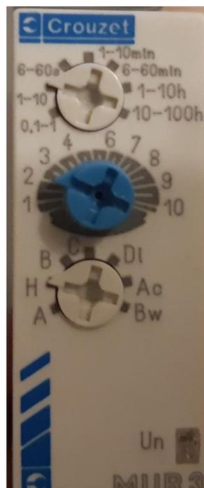
Lorsque le relais est alimenté (**U**), le contact (**R**) bascule immédiatement le temps de la tempo (**T**) puis repasse au repos.
